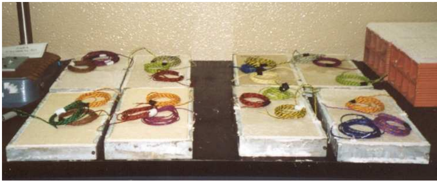
Fig. 5 – Conjunto de provetes para o ensaio de capacidade de protecção contra a água
