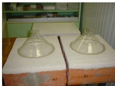
Figura 4 - Provetes para o ensaio de permeabilidade à água sob pressão (reboco 2)
