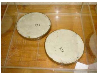
Figura 3 - Ensaio de determinação do coeficiente de absorção de água por capilaridade (reboco 1)
