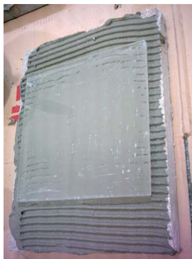
Figura 8 – Situação para o caso em que foi conferido um ligeiro movimento horizontal ao ladrilho
