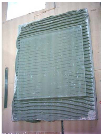
Figura 7 – Situação após a aplicação de um peso de 10 kg
