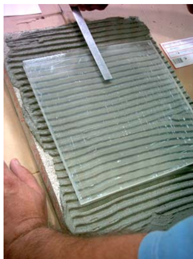
Figura 6 – Medição do espaçamento médio entre cordões de cola, após a aplicação de um peso de 1kg
