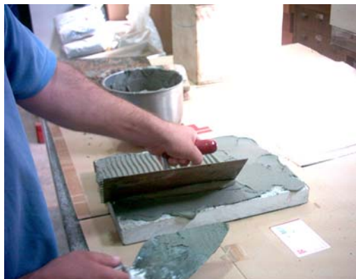
Figura 5 – Distribuição da cola sobre o suporte de teste, utilizando a espátula denteada
