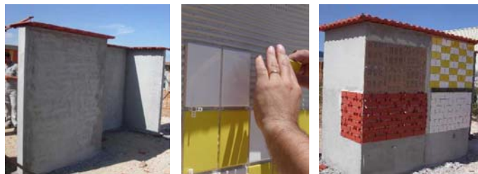
Figura 5 – Estação de envelhecimento natural.
