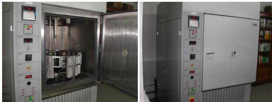
Figura 6 – Painel de controlo e interior da câmara Fitoclima 600 EDTU .
