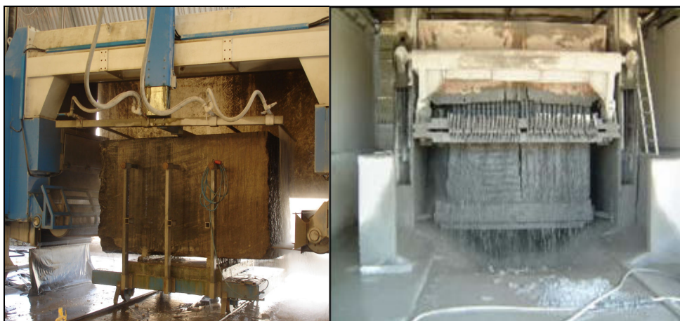
(a) Tear de fios diamantados; (b) Tear de lâminas metálicas [4].
