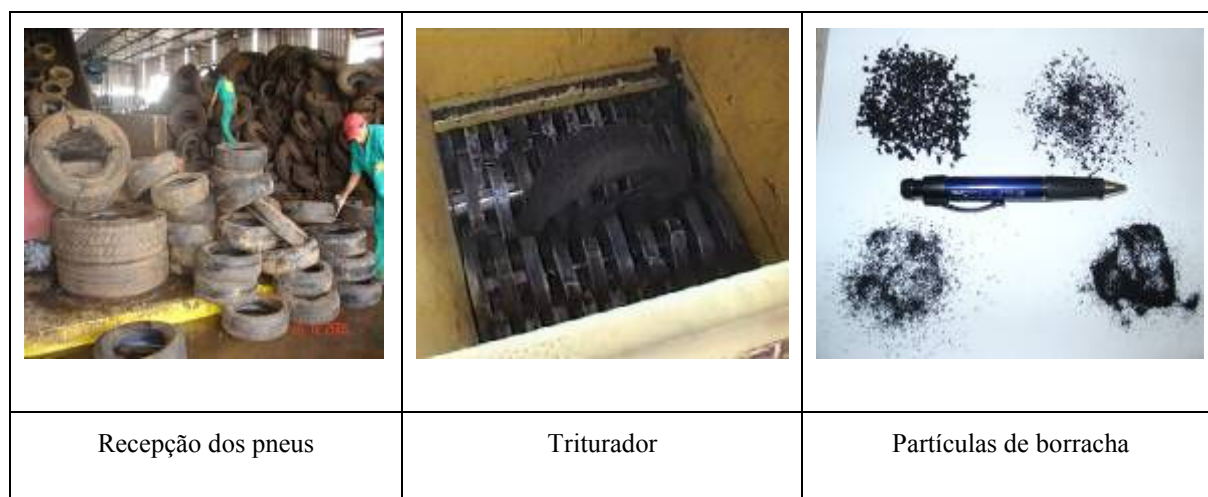
Figura 2 – Processamento de pneus.
