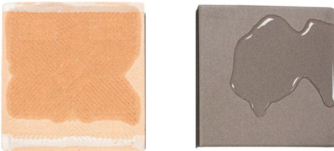
**Fig. 11** - Exemplo de teste rápido empírico para determinação da absorção de água (peça da esquerda é mais absorvente e a da direita é menos absorvente)
