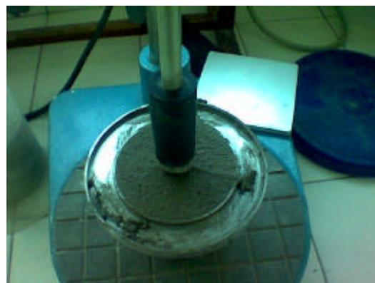
**Figura 40: Determinação da consistência pelo método do punção de penetração**
