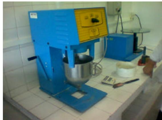
**Figura 38: Preparação das amostra: pesagem e mistura das argamassas**
