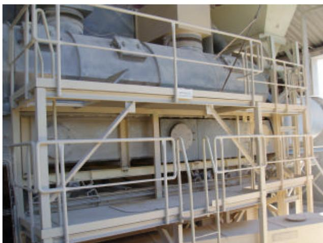
**Figura 8: Secador de leito Fluidizado**
