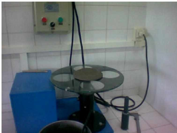
**Figura 39: Determinação da consistência pelo método da mesa de espalhamento**
